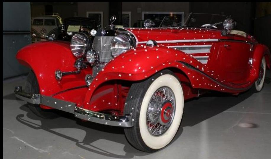
Первый шаг при создании 3D-модели – лазерное сканирование реального олдтаймера, в результате которого бесконтактно определяется положение от сотен тысяч до десятков миллионов точек на поверхности оригинала. Полученные «сканы» сводятся в единую систему координат и обрабатываются: корректируются ошибки и уточняется положение еще не отсканированных участков поверхности.
