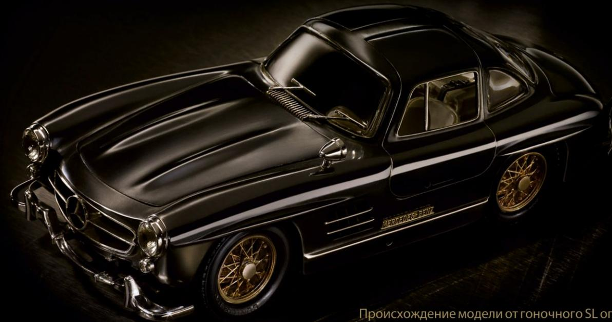
Происхождение модели от гоночного SL определило знаковую конструктивную особенность Мерседес 300 SL – конструкцию дверей «крыло чайки», что решало проблему, связанную с высокими внешними элементами пространственной рамы. С 1954 по 1956 год было выпущено 1400 автомобилей Mercedes 300SL Gullwing.
